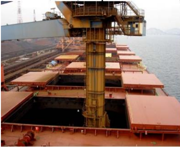
Мал. 9. Відкочуючися закриття на балкері
