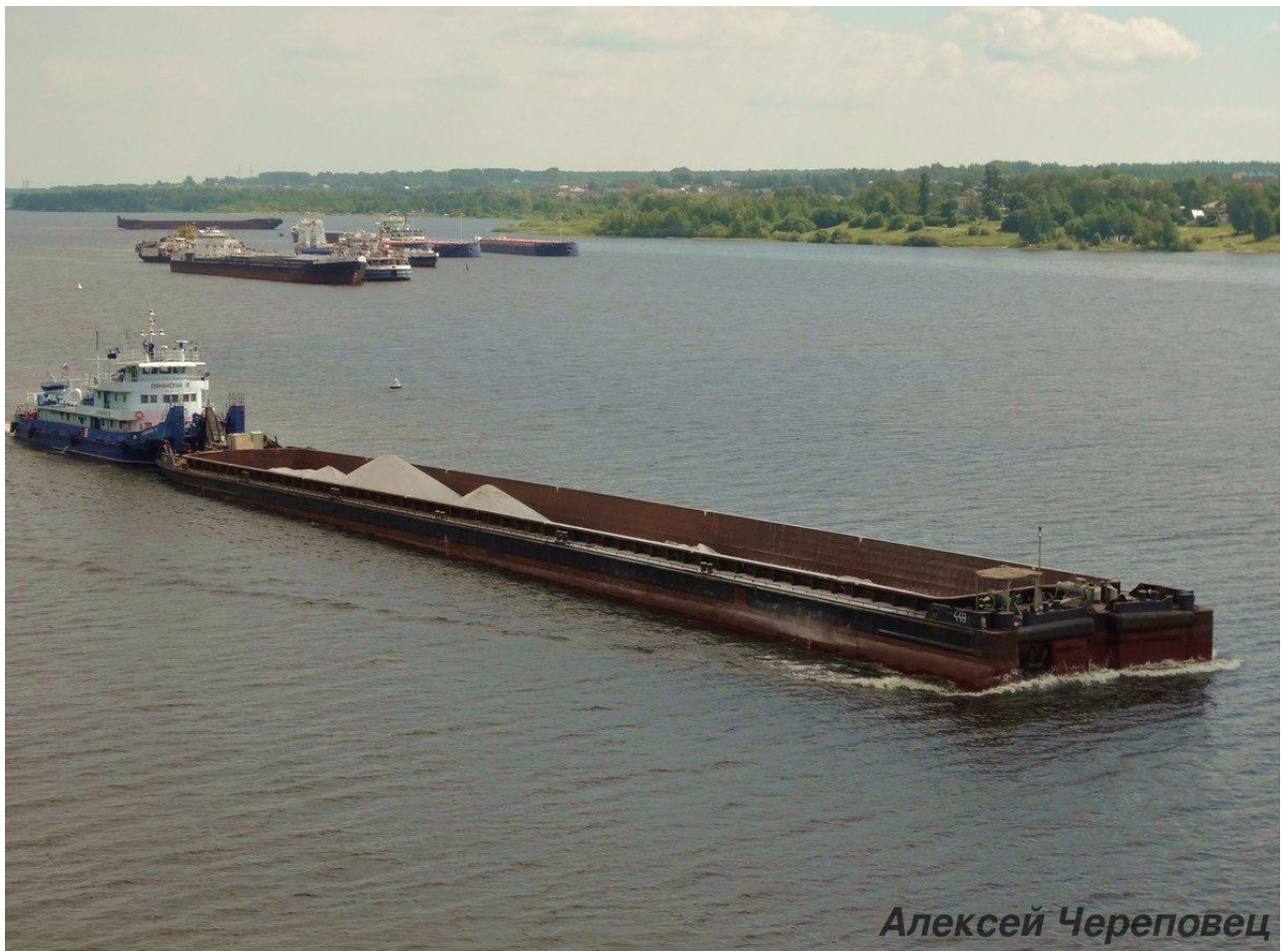
Мал.5. Буксирування методом штовхання (буксир-штовхач Дунайський-18 на річці Дунай).
