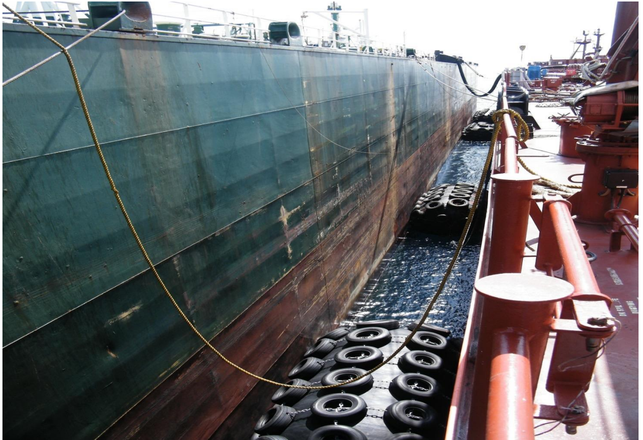
Мал. 10. Плаваючі пневматичні кранці між бортів двох судів
