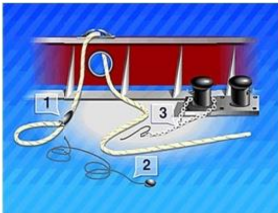
Мал. 6. Підготовлене для швартування робоче місце: 1 - швартується, 2 - викидання, 3 - переносний ланцюгової стопор.
