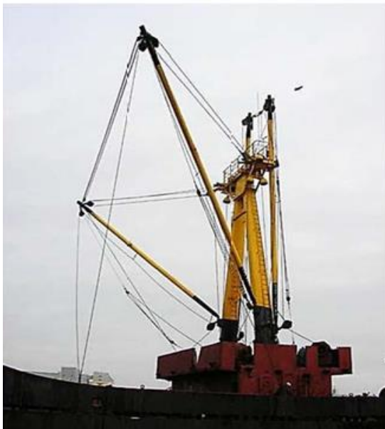
Мал. 1. Легка вантажна стріла: 1 - щогла; 2 - топенант; 3 - вантажний блок; 4 - вантажний шкентель; 5 - вантажний гак; 6 - відтяжка; 7 - стріла; 8 - канат на турачку вантажної лебідки; 9 - канат на барабан вантажної лебідки; 10 - Лопарев топенанта; 11 - черевик; 12 - шпор стріли; 13 - нок стріли; 14 - бугель; 15 - топенант-блок.
