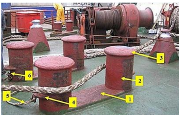
Мал. 10. Кнехти: 1 - підстава; 2 - тумба; 3 - капелюшок; 4 - прилив; 5 - стопор; 6 - обух. на кнехті.
