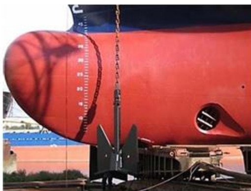
Мал. 3. Носова підрулюючий пристрій і підрулюючий пристрій в роботі.
