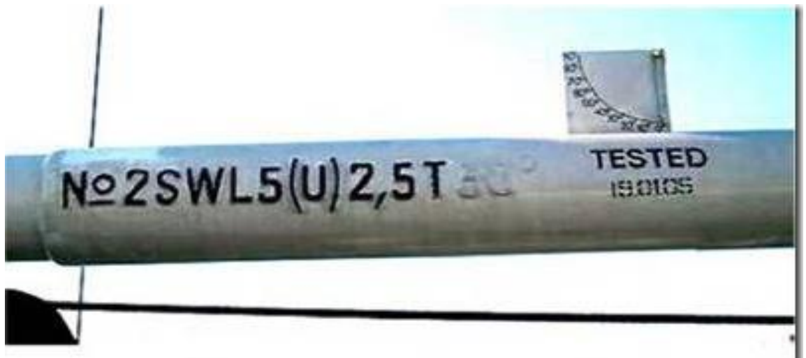
Мал. 5. Маркування вантажний стріли: вантажопідйомність 5 т при нахилі стріли до горизонту не менше 30^\circ і 2,5 т при роботі спареними стрілами.
