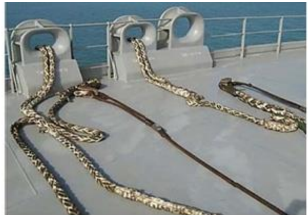
Мал. 6. Підготовлене для швартування робоче місце: 1 - швартується, 2 - викидання, 3 - переносний ланцюгової стопор.
