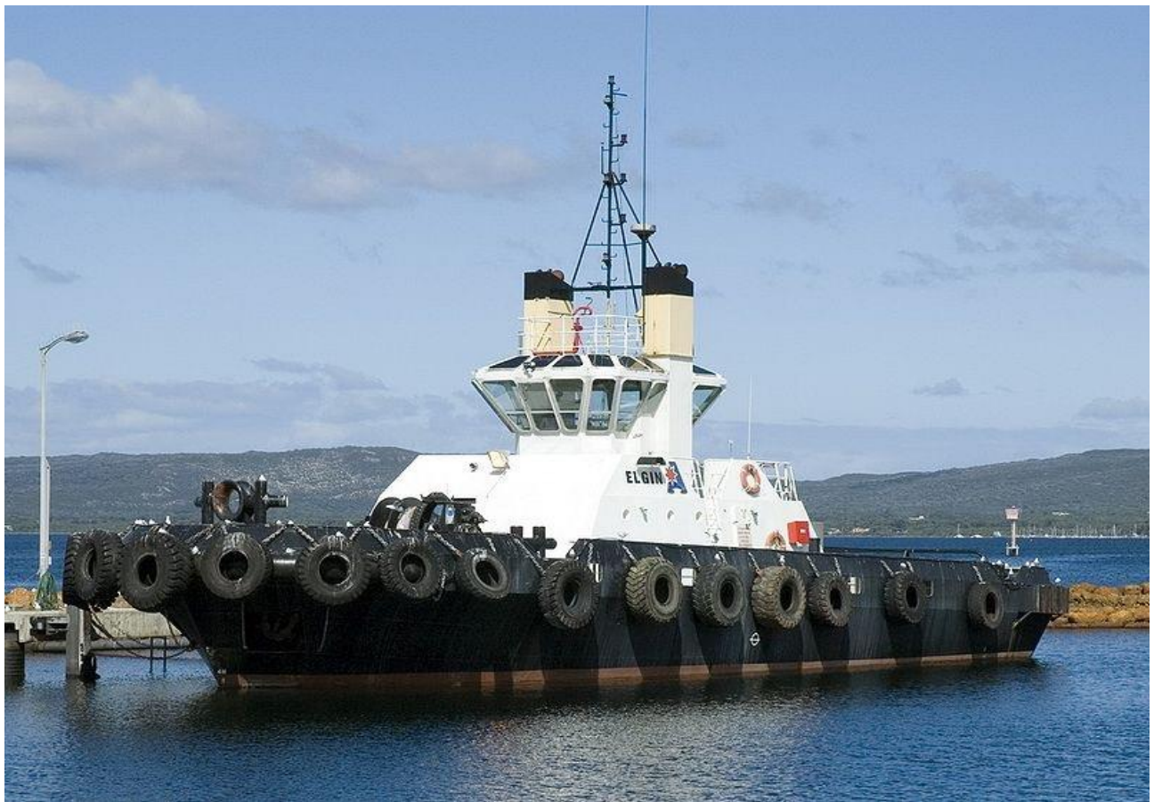
Мал. 12. кранцевое захист з автомобільних покришок
