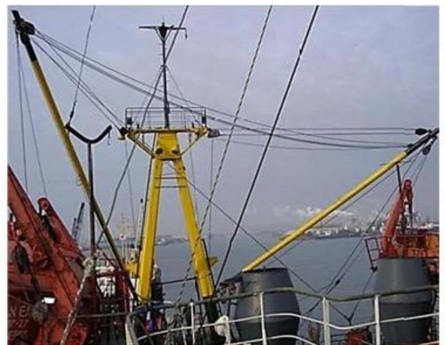
Мал. 2. Робота легкими стрілами «на телефон»: 1 - відтягнення; 2 - контроттяжки; 3 - гак; 4 - топриком; 5 - вантажні шкентеля.
