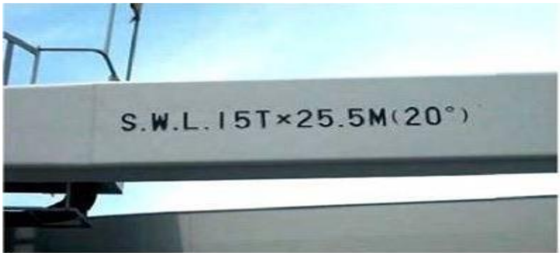
Мал. 6. Маркування вантажного крана: вантажопідйомність 15 т при вильоті стріли 25,5 м і нахилі стріли не менш 20°.
