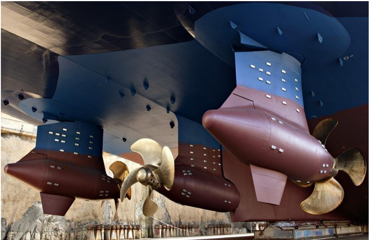
Мал. 7. Гвинт-кермові колонки AZIPOD
