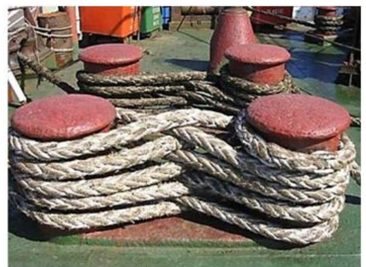
Мал.11.Кріплення швартовного троса.
