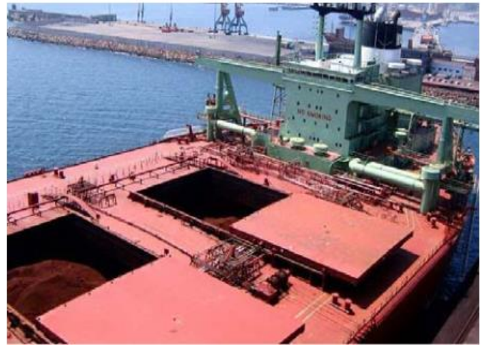
Мал. 9. Відкочуючися закриття на балкері
