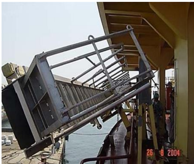
Мал. 4. Прибирання трапа по-похідному
