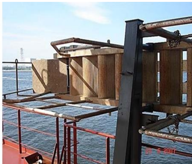
Мал. 4. Прибирання трапа по-похідному
